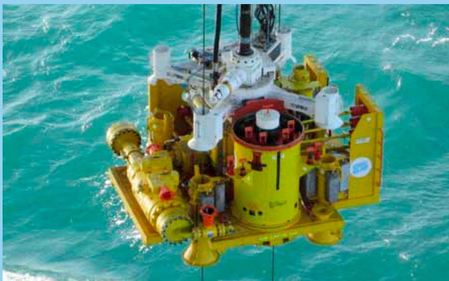
Zelfregelende olie en gasput. De onderzeese putafwerking voor op de zeebodem (foto Dana Petroleum Netherlands B.V.)
