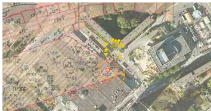
Heerlen: De hoekpunt van de ondiepe kolenwinning (rood/zwart) en de rekscheuren (geel) uit 1956 bij 't Loon, met het zakkingsgebied (oranje) en de uiteindelijke, snelle, lokale verzakking (rood) (foto SodM)
