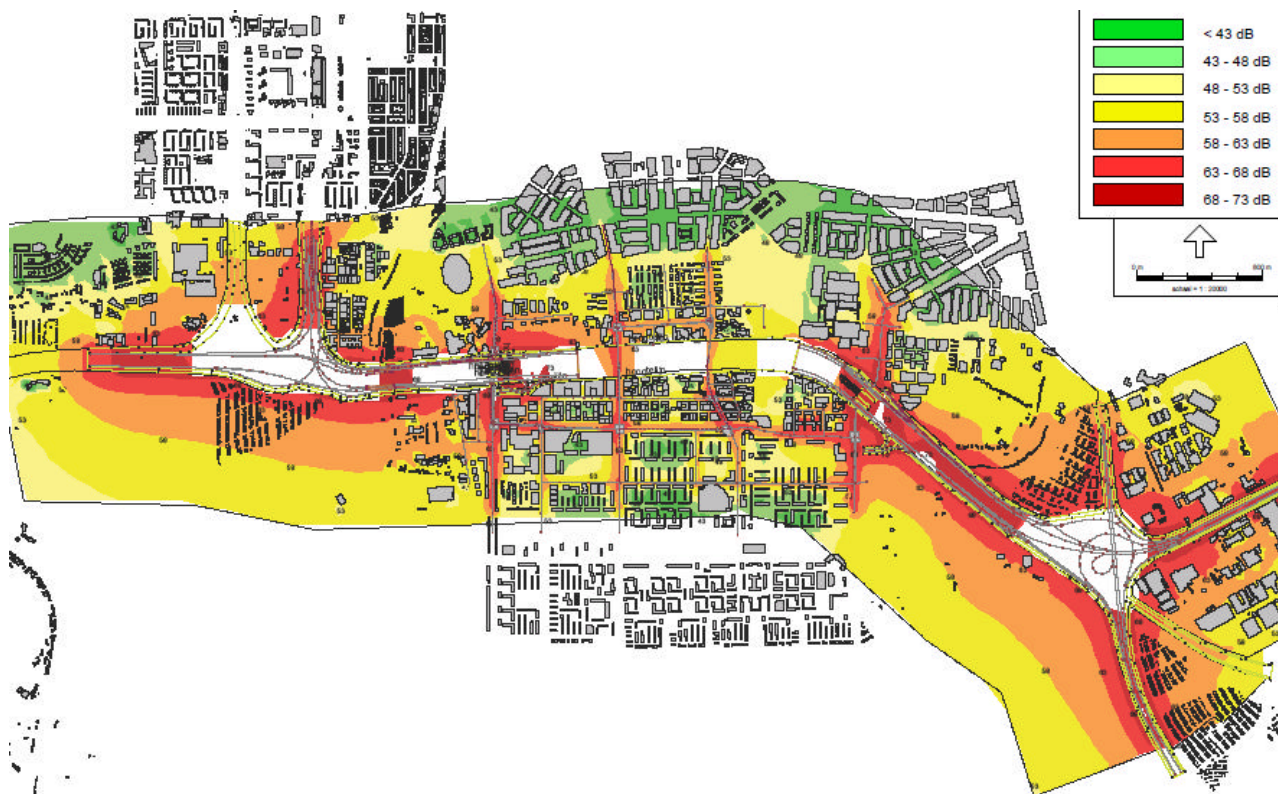
figuur 10.17 Geluidcontouren wegverkeer gecumuleerd MLT
