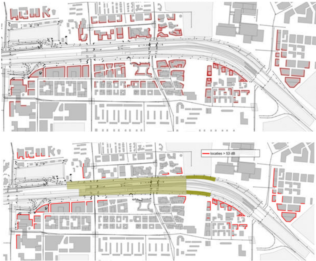
figuur 15.1 Gevels met een geluidbelasting boven de maximale ontheffingswaarde A10 in de referentiesituatie (boven) en met de realisatie van een korte tunnel en een 'luifelconstructie' (inclusief dubbellaags ZOAB)
