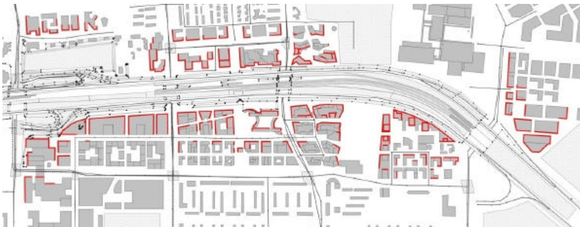
figuur 10.4 Gevels met een geluidbelasting >53 dB als gevolg van de A10 in de referentiesituatie
