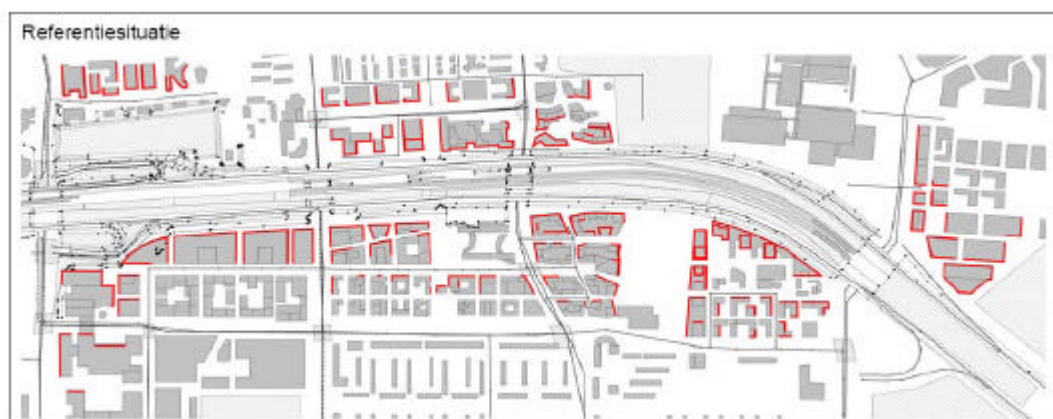
Figuur 0.3 Gevels in de referentiesituatie met een belasting van meer dan 53 dB als gevolg van de A10
