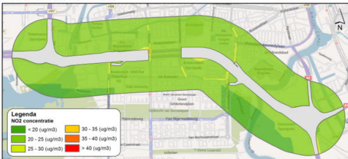
figuur 9.5 MLT 2020 concentraties jaargemiddelde concentraties NO 2 (boven lange tunnel, onder korte tunnel)
