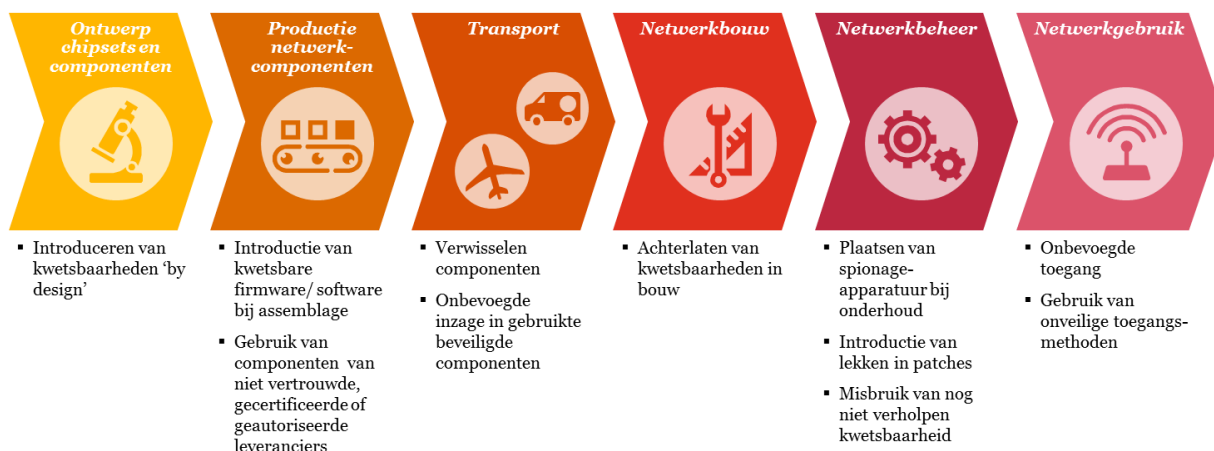
Figuur 2. De stappen in de productieketen van een ICT-netwerk, inclusief voorbeelden van risico's in elke stap.
