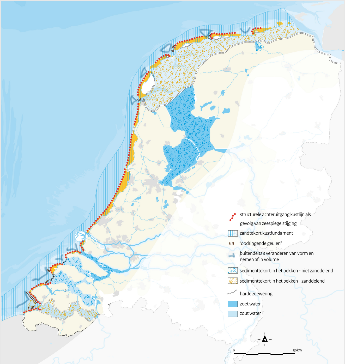
Figuur 10 Processen in het zandig systeem
