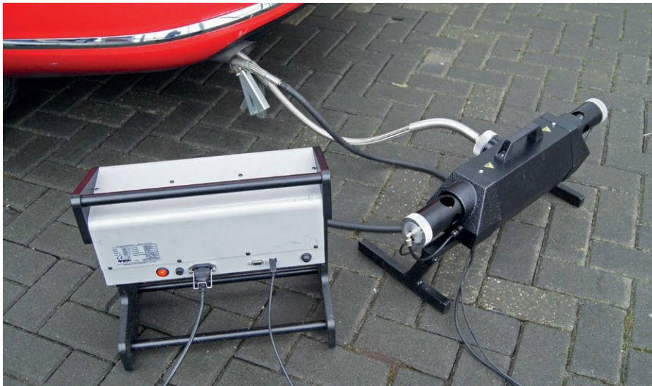
Figuur 14. In het onderzoek van 2016 zijn de absorptiecoëfficiënten gemeten met twee typen rookmeter: een conventionele of 'standaard' rook- of opaciteitsmeter zoals die nu wordt gebruikt in de APK (rechts) en een moderne, 'verbeterde' rook- of opaciteitsmeter (links), met een hogere nauwkeurigheid dan de oude meters. Een roetmeting wordt uitgevoerd 'bij vrije acceleratie': het gaspedaal wordt maximaal ingetrapt en zo wordt de maximale rookemissie gemeten (foto: TNO).
