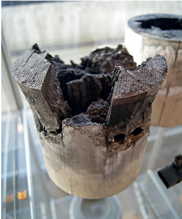
Figuur 7. Een volledig verwoest roetfilter. Doorrijden met een verzadigd roetfilter kan het roetfilter onherstelbaar beschadigen en zelfs ernstige motorschade veroorzaken (foto: TNO bij Digicar Engineering).
