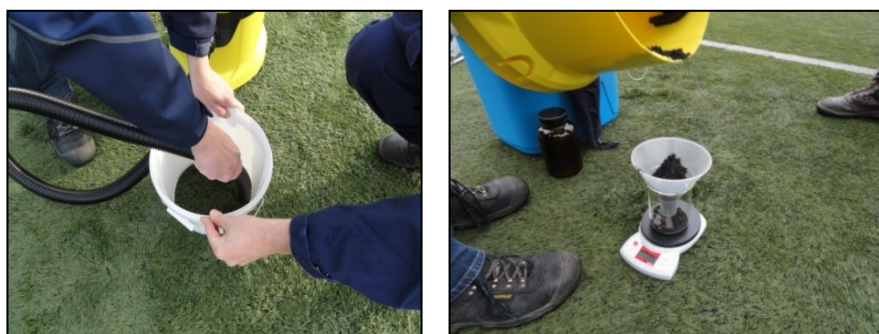
Figuur 4 Bemonstering van rubbergranulaat met een stofzuiger (links) en vulling van een glazen pot met het bemonsterde materiaal (rechts)
