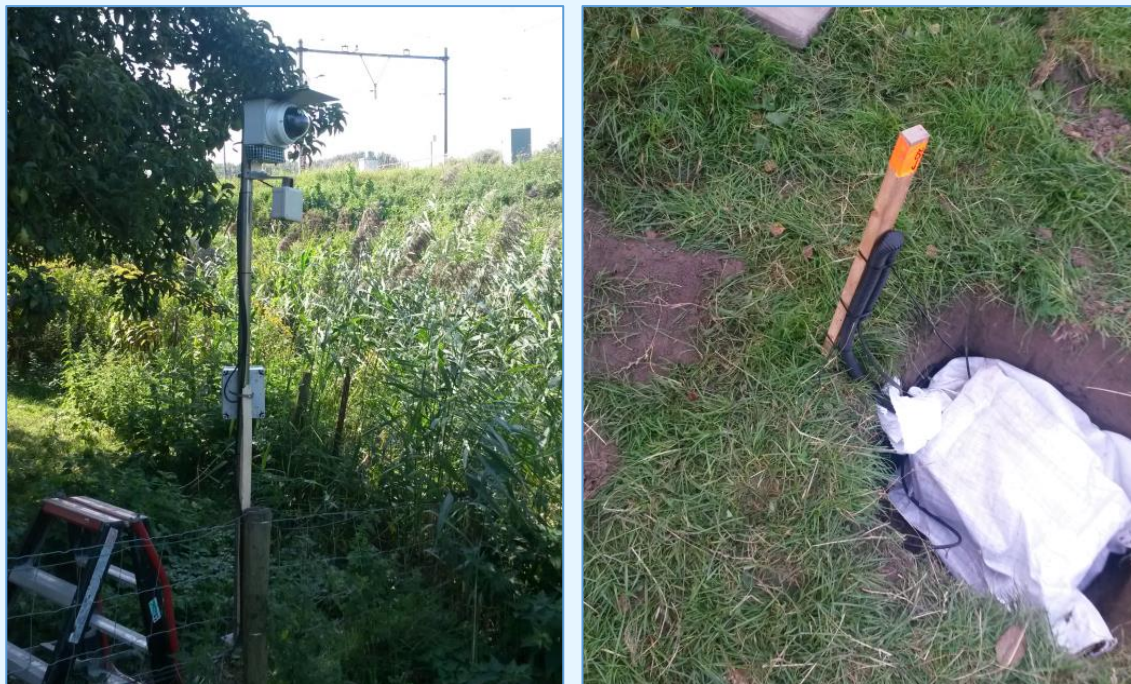
figuur 5: meetopstelling: radar en webcam (l) en meetkoffer (r)
