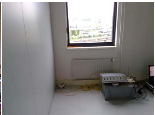
Figuur 4: Versnellingsopnemers ter plekke van de fundering (links) en op de eerste verdieping (rechts) bij de referentieband aan de van Dusseldorpstraat nr.5.
