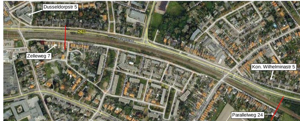
Figuur 2: Overzicht langdurige meting. Naast de referentiepanden (van Dusseldorpstraat en Koningin Wilhelminastraat) zijn de twee locaties weergegeven waar treinpassages zijn opgenomen (rode lijnen).
