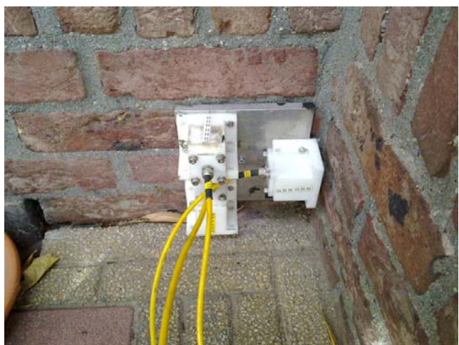
Figuur 5: Referentieband aan de Koningin Wilhelminastraat 5. Links: positie en richting versnellingsopnemers. Rechts: Versnellingsopnemers ter plekke van de fundering..
