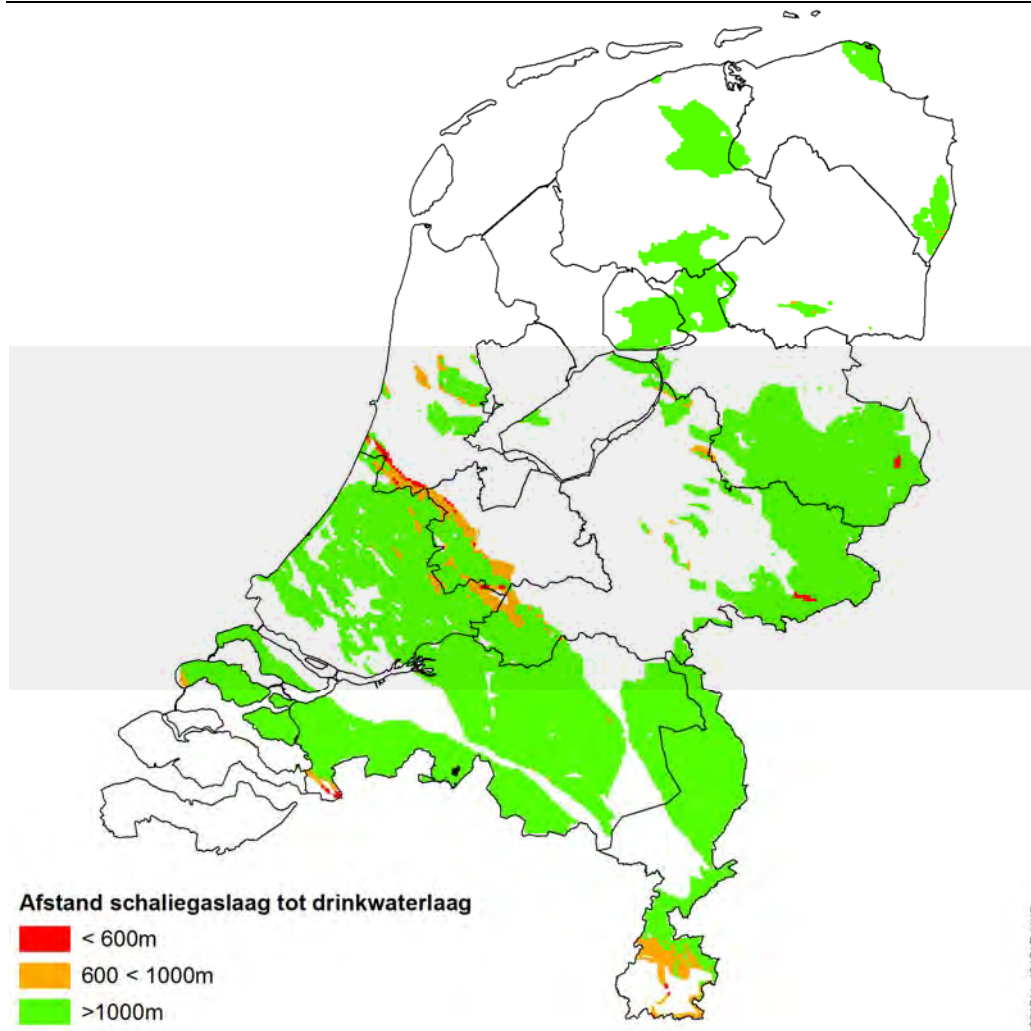
Figuur 4.46 Ligging schaliegas-laag ten opzichte van de waterlaag
