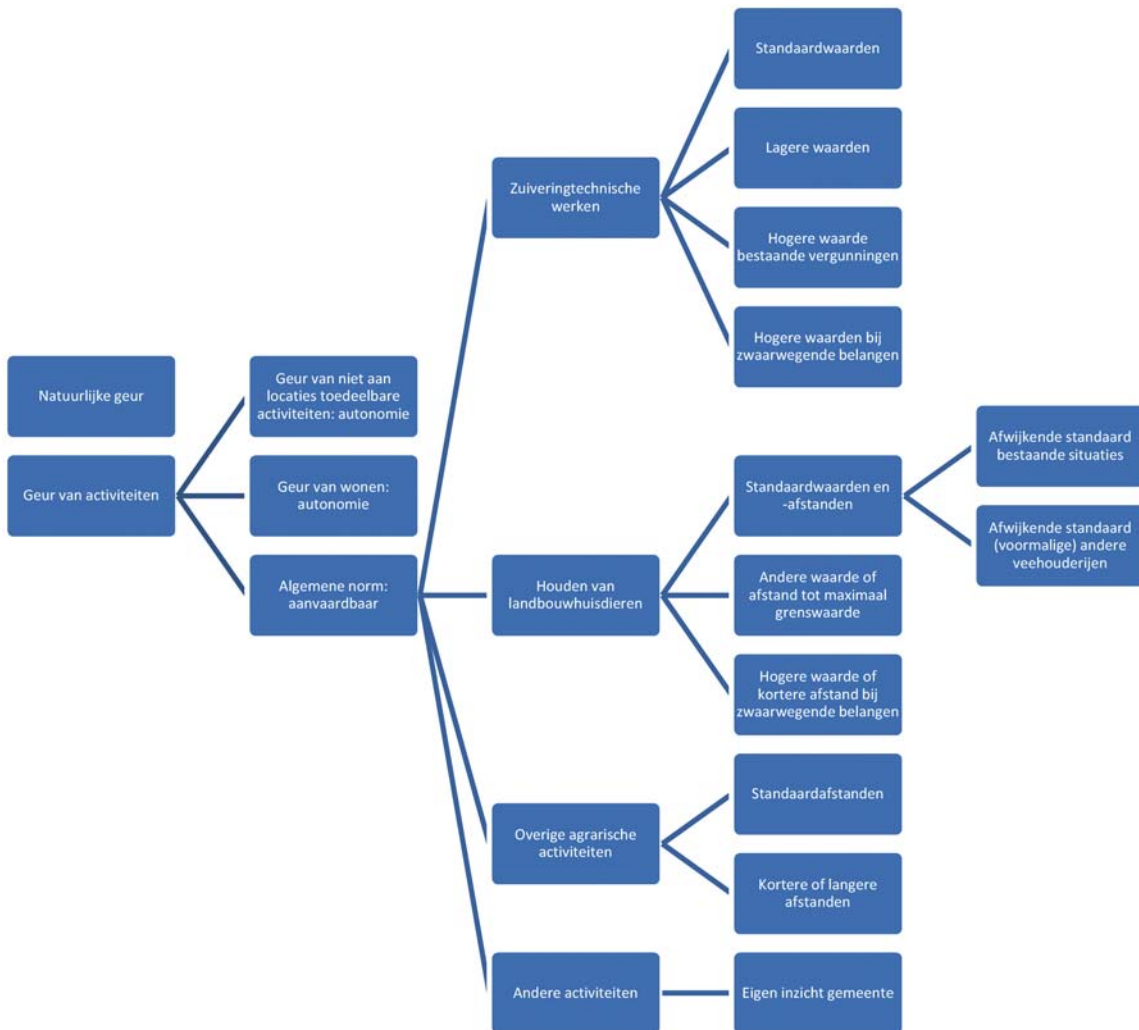
Figuur 8.8. Schematische weergave van de hoofdlijnen van de regels voor geur. Uitzonderingen voor specifieke gebouwen en activiteiten zijn hier omwille van het overzicht weggelaten.
