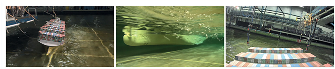
Figuur 15: Foto's van het scheepsmodel in het MARIN testbassin, respectievelijk met beelden bovenwater, onderwater en vanaf de brug van het schip.
