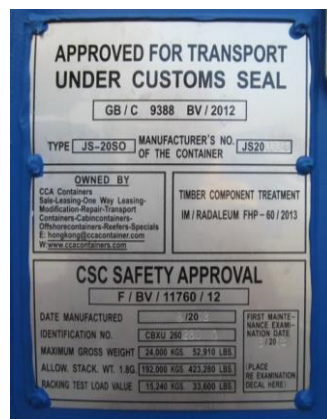
Afbeelding 9: CSC Safety Approval Plate [18]
