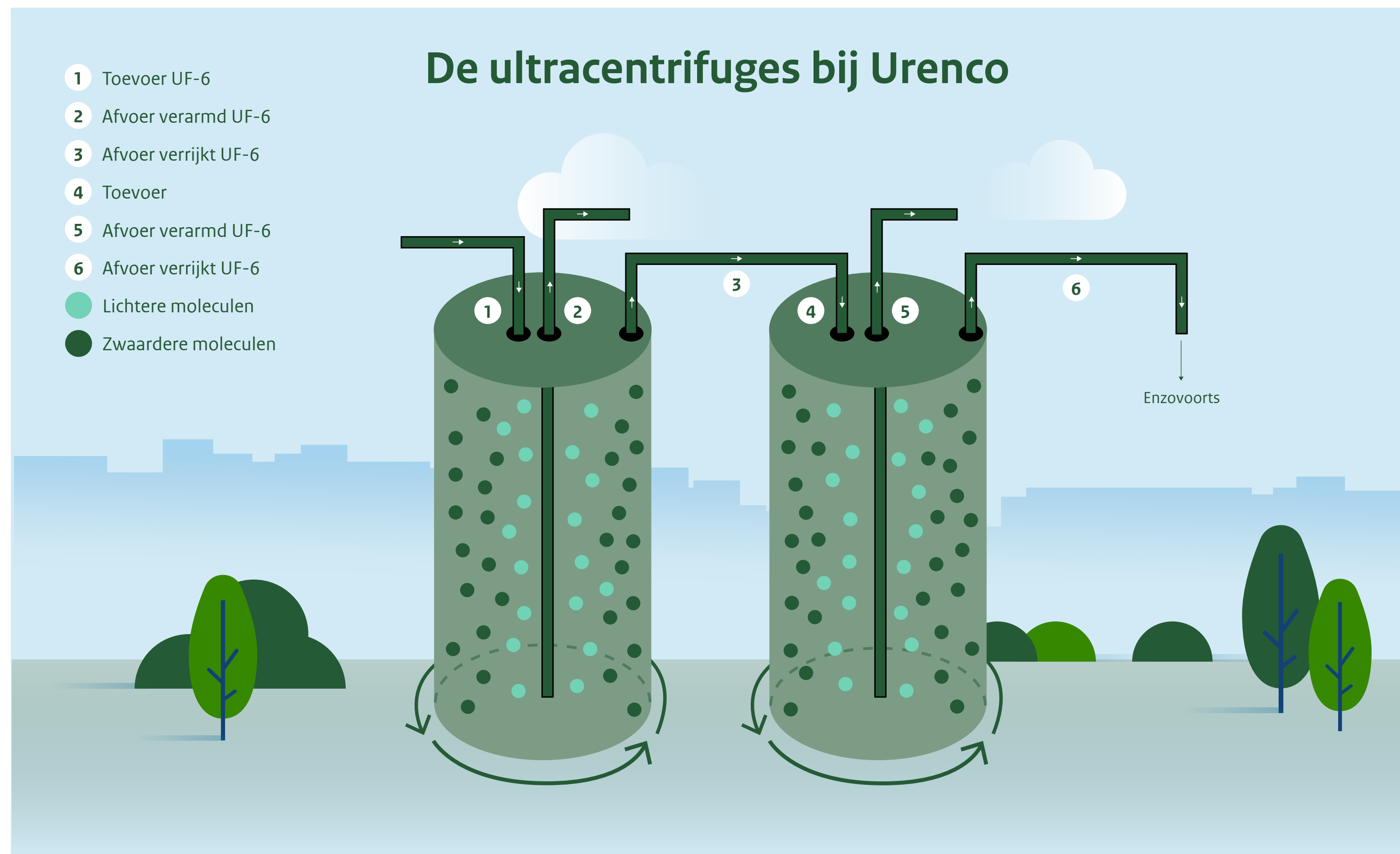
Vereenvoudigde weergave van de werking van de ultracentrifuges bij Urenco in Almelo.
