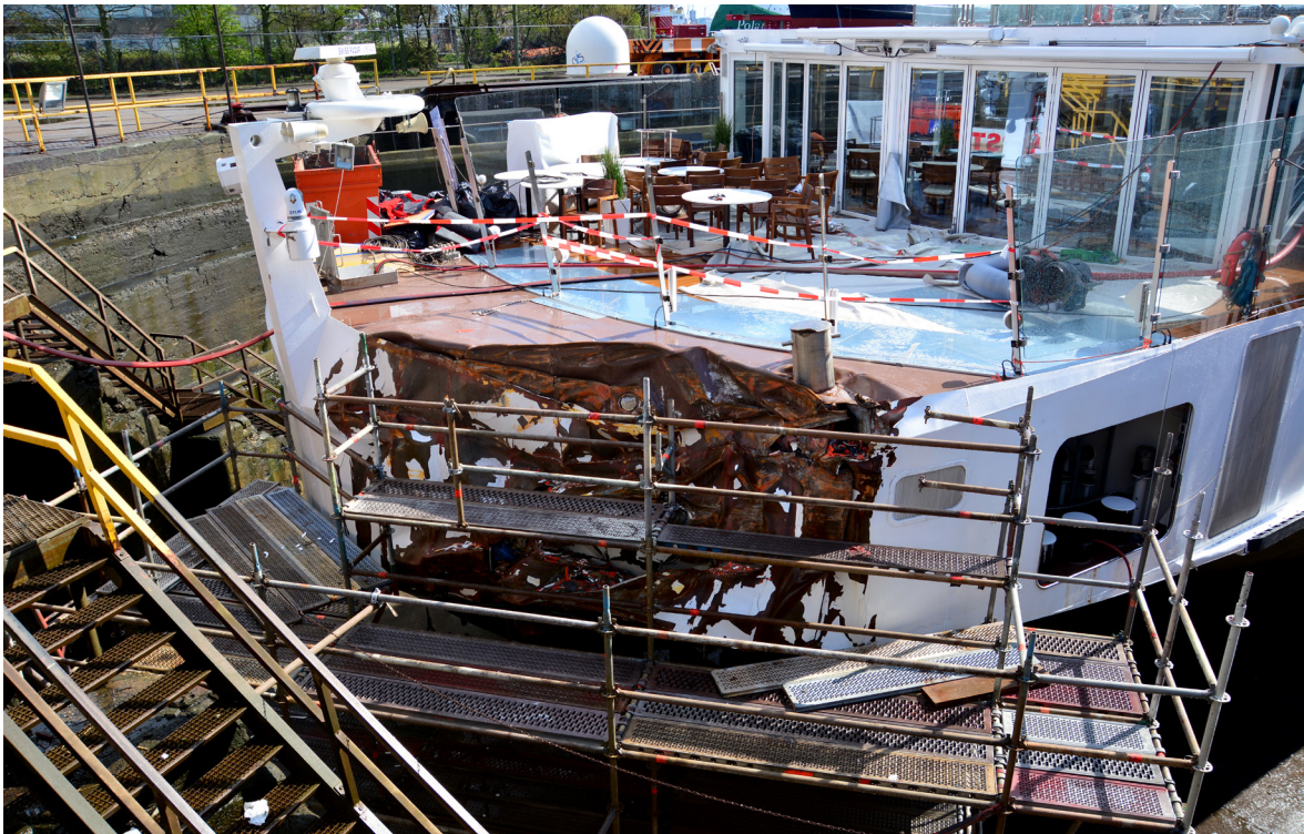
Figuur 7: De schade aan de boeg van de Viking Idun, gefotografeerd in het droogdok.
