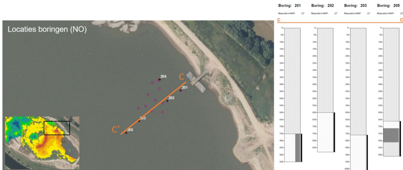
Afbeelding 5.7 Links, controleboringen deellocatie NO Westplas inclusief loslocaties granuliet, rechts profielen boringen raai C – C'
