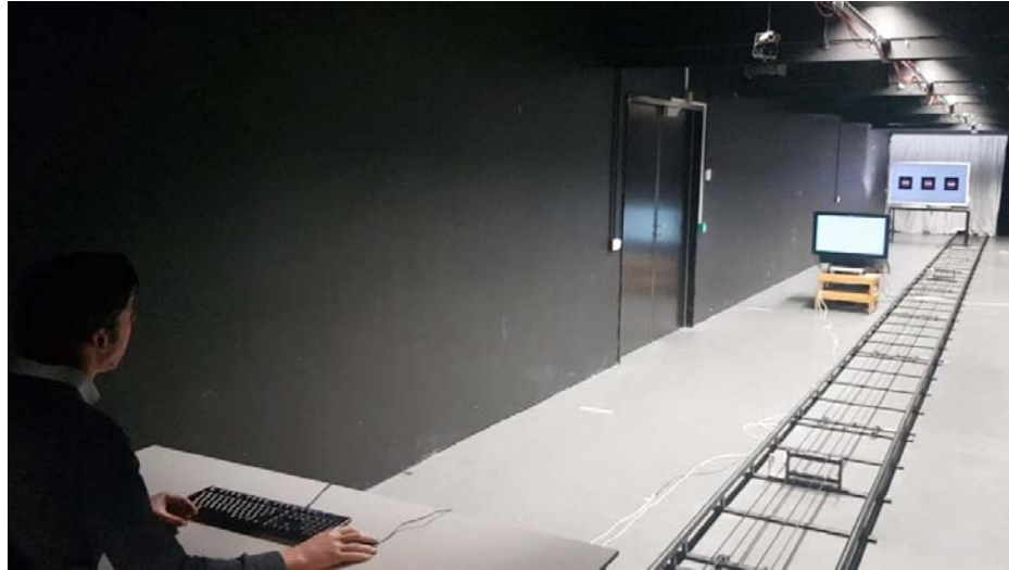
Figuur 6 De proefopstelling. Op het eerste scherm (10 m) wordt een tracking taak weergegeven, op het tweede scherm (20 m) worden de borden getoond.
