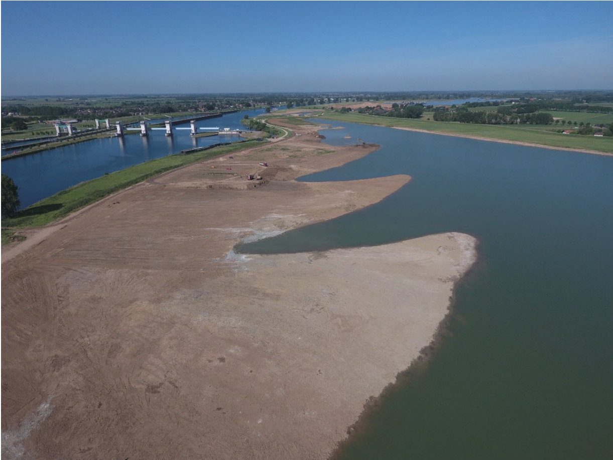
Figuur 2 Dronefoto ten tijde van de laatste handelingen voor de afdeklaag datum 1 juni 2017 (Bron: Over de Maas CV). Tussen de oostelijke landtongen zijn grijze vlekken aan de oppervlakte met mogelijk granuliet herkenbaar.
