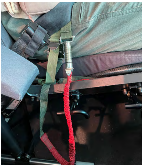
Figuur 26 Snelsluiser tussen groene en rode deel van veiligheidslijn, veiligheidslijn hangt naast de stoel (bron IVD)
