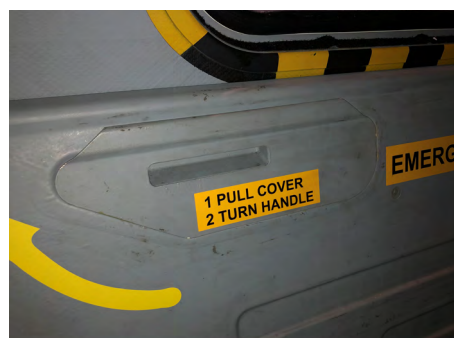
Figuur 25 Afdekluisje hendel uitwerpmechanisme cabinedeur (bron IVD)
