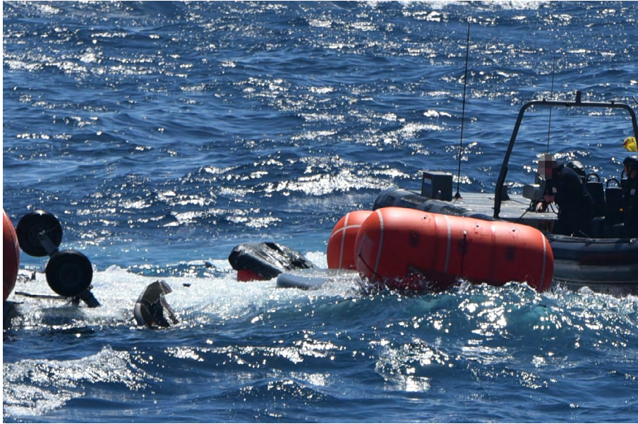
Figuur 28 Aankomst eerste FRISC bij het wrak, drijflichamen, landingsgestel en delen van de rotorbladen steken boven water uit, het reddingsvlot van de vlieger drijft ter hoogte van de cockpit (bron fotograaf Zr.Ms. Groningen)
