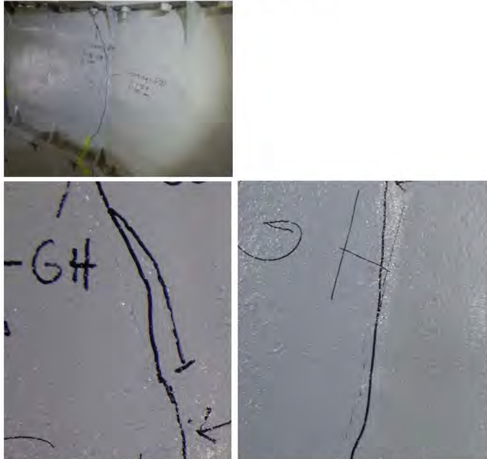
Figuur 2.1 Foto's van de grootste scheur (lengte circa 860 mm). Boven: overzichtsfoto nr. 9117 opgenomen in [4]. Onder: ingezoomd op detailfoto's nrs. 9118 en 9119 verstrekt door Nebest.
