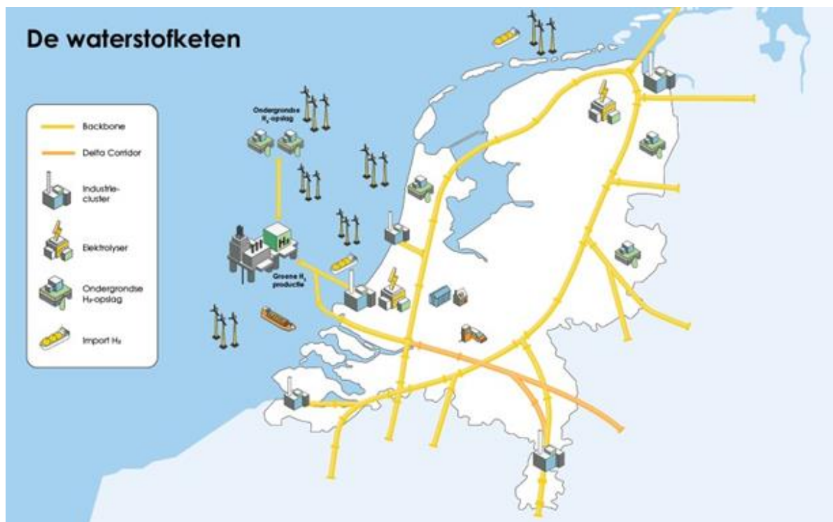
Figuur 2-1: Schets van de (mogelijke) waterstofketen op basis van bestaande projecten waarin waterstofproductie, -opslag en -gebruik verbonden zijn door grootschalig pijpleidingennetwerk dat ook verbonden is met het buitenland. Locaties zijn indicatief.
