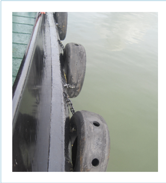
Figuur 8: Banden ter bescherming buitenzijde sleepboot.
