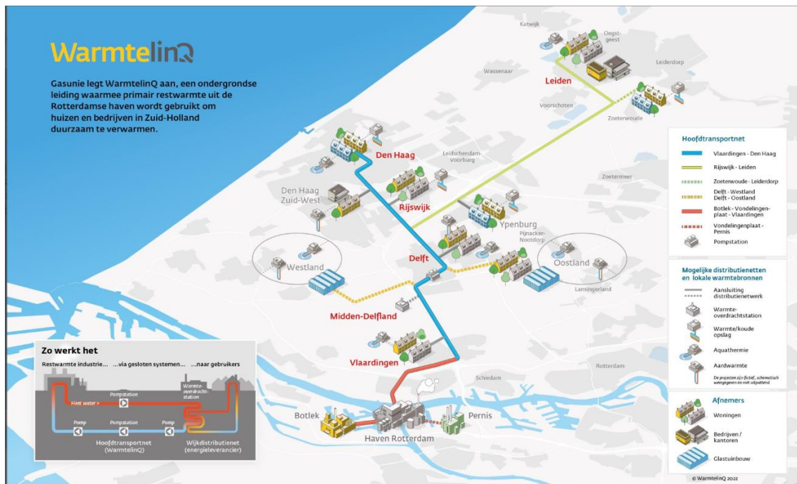
Figuur 5-2 - Overzicht van leidingen binnen WarmtelinQ
