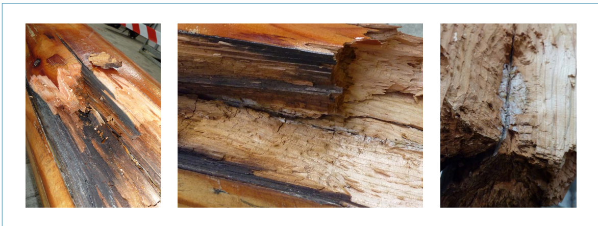
Figuur 7: Houtrot (foto's links) en schimmel (foto rechts) op de breukvlakken.
