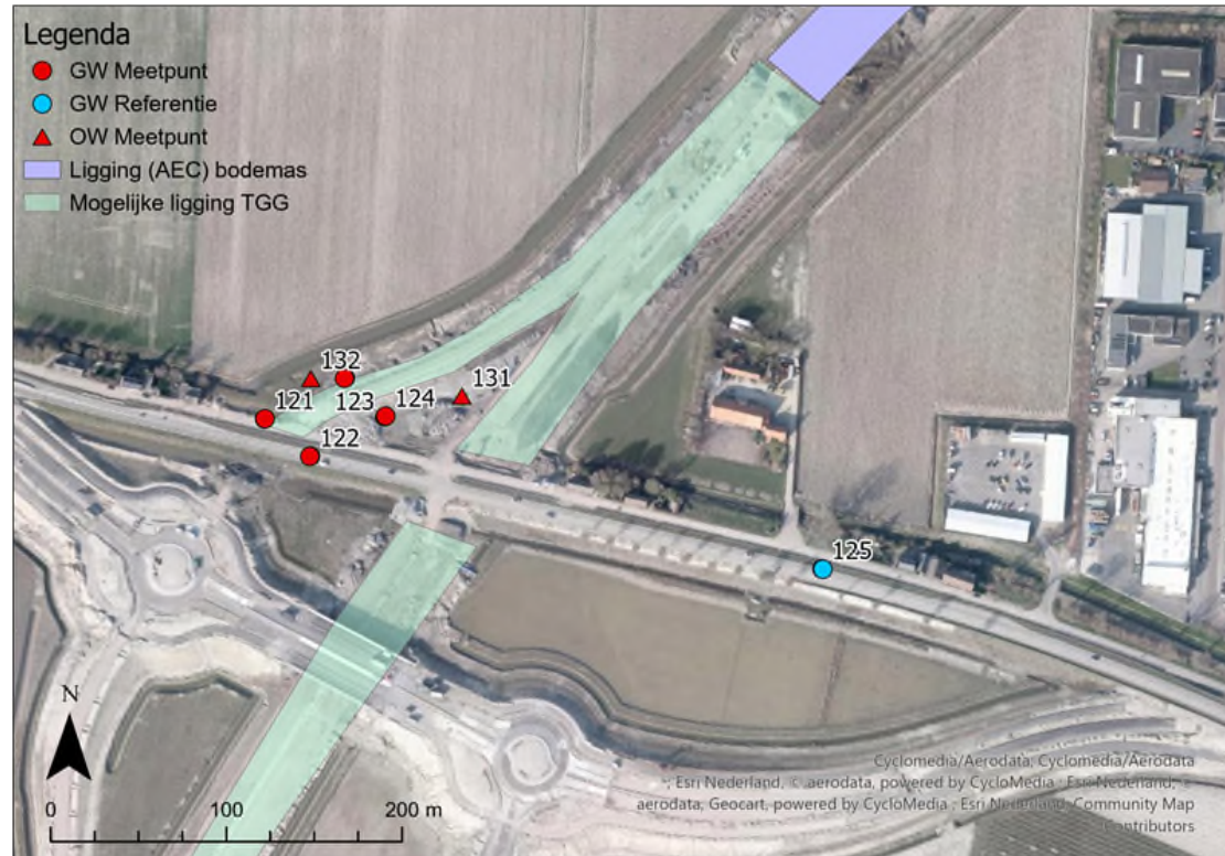
Figuur B1.1 Luchtfoto uit 2014 van A4 Steenbergen deellocatie Zeelandweg-Oost tijdens de aanleg met in groen de contour van de waarschijnlijke ligging van de TGG en punten van het monitoringsnetwerk. NB monsterpunt 133 voor het oppervlaktewater bevindt zich niet op de kaart (is meer naar het westen gesitueerd)
