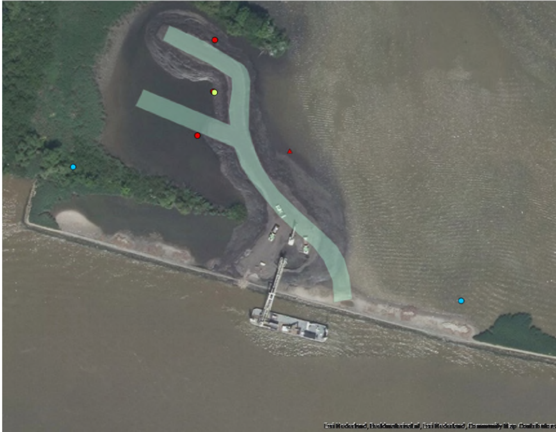
Figuur B1.2 Luchtfoto uit 2016 van De Kleine Zaag tijdens de aanleg met daarop de contour van de TGG. Het monitoringsnetwerk is weergegeven met in blauwe bollen referentiepeilbuizen, rode/gele bollen de peilbuizen en rode driehoek bemonsteringspunt voor het oppervlaktewater). NB monsterpunt 312 voor het oppervlaktewater bevindt zich niet op de kaart (is meer naar het oosten gesitueerd)
