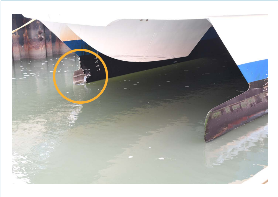
Figuur 4: Schade aan de stuurboord bulbsteven van de snelboot. De punt van de steven mist. (Bron: Politie)
