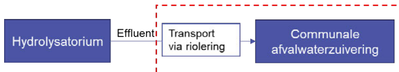
Figuur 5.2 Scope LCA model ‘Aerobe zuivering’. De rode lijn geeft de meegenomen scope weer
