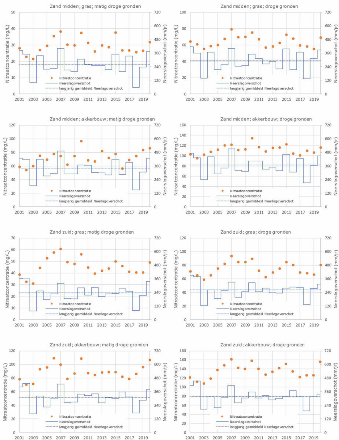
Figuur 6.2.12 Berekend verloop van het netto-neerslagoverschot en nitraatconcentraties van grasland en akkerbouw op zand in de regio Zand midden en Zand zuid bij een jaarlijks gelijke mestgift afgestemd op de gebruiksnormen van het 6 e Actieprogramma Nitraat.
