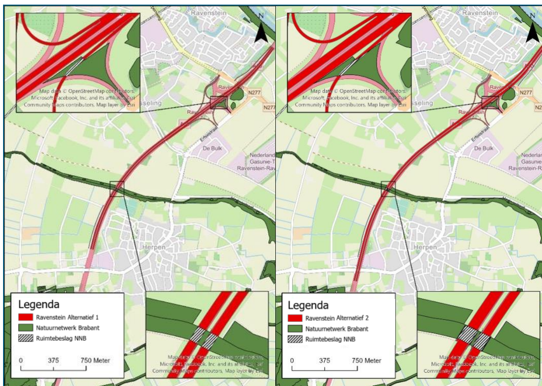
Afbeelding 9.3.4. Links ligging van alternatief 3 van traject Ravenstein ten opzichte van het NNB en het ruimtebeslag. Rechts ligging van alternatief 10 ter hoogte van Ravenstein ten opzichte van het NNB en het ruimtebeslag.
