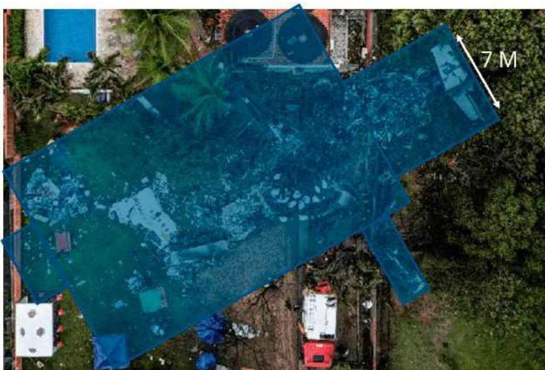
Figuur 4-1: Voorbeeld van het bepalen van het brokstukkengebied aan de hand van een foto
