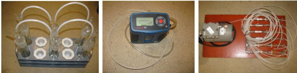
Figuur A2 Meetopstelling WLR voor NH 3 - protocolaire metingen. Links: wasflessen. Midden: Droge gasstroommeter (DryCal® Defender 510-m, Bios Int. Corp, VS). Rechts: pomp (Thomas Industries Inc., model 617CD32, Wabasha, Minnesota, VS), monsternamleiding (teflon of polyethyleen) en kritische openingen (borosilicaatglas (diameter: 8 mm; lengte: 80 mm), gehuisvest in a roestvrijstaal container voor bescherming).
