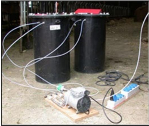
Figuur A3 Meetopstelling WLR voor geur- en broeikasgas- protocolaire metingen (via longmethode). Gesloten vaten met 40 liter Nalophan monsternamenamezakken voor luchtmonstering, monsternamenameleiding (tefflon of polyethyleen) en kritische openingen (borosilicaatglas (binnendiameter: 8 mm; lengte: 80 mm), ondergebracht in een roestvrijstalen container voor bescherming; flow: ~ 20 ml/min voor broeikasgassen, ~0,4 l/min voor geur). Lucht wordt met behulp van een pomp (Thomas Industries Inc., model 617CD32, Wabasha, Minnesota, VS) uit het vat gezogen, waardoor de lucht in de zakken wordt aangezogen.
