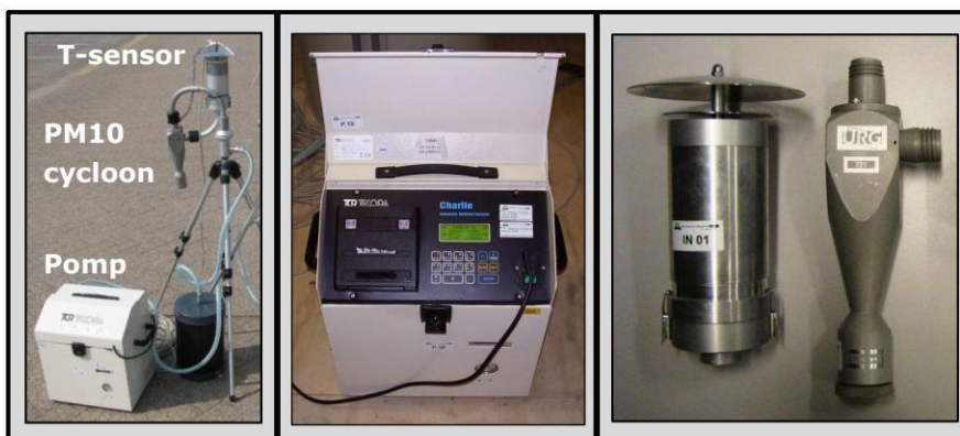
Figuur A4 Gravimetrische methode voor het meten van PM10-concentraties. Lucht wordt door inlaat, cycloon en filter gezogen met behulp van monsternamenamepompen van het type Charlie HV (roterend, 6 m 3 /uur, Ravebo Supply BV, Brielle), geprogrammeerd op een flow van 1,0 m 3 /uur.
