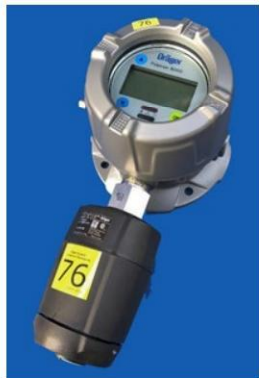
Figuur A1 Links: Dräger Polytron 8000 met de FL-6813260 sensor voor \text{NH}_3 -concentratiemetingen. Midden: Vaisala CARBOCAP® met GMP252 sensor voor \text{CO}_2 -concentratiemetingen. Rechts: ABB EasyLine EL3000 met Uras26 sensor voor \text{CH}_4 -concentratiemetingen.
