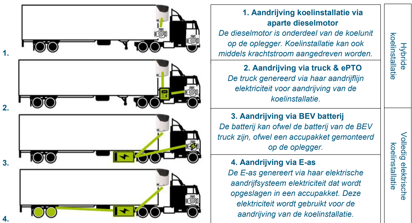
Figuur 1: Vier voorbeelden van een trekker met oplegger met verschillende type aandrijvingen van een koelinstallatie
