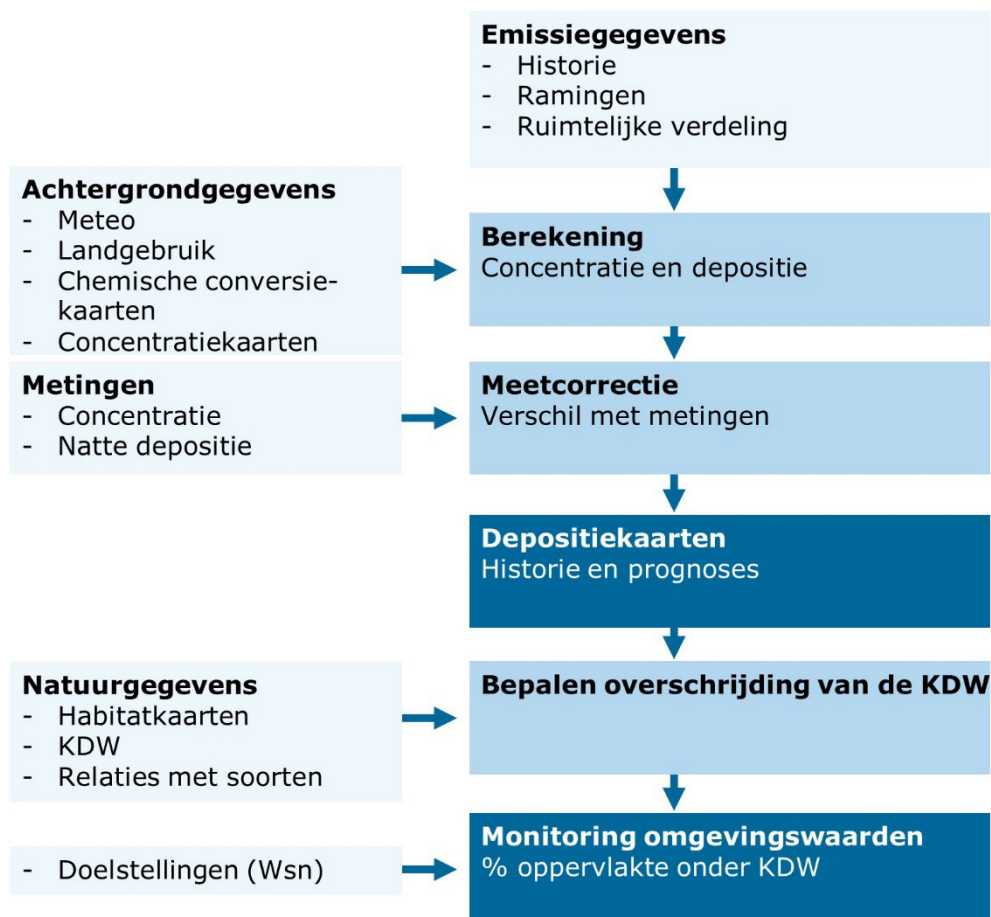
Figuur 3.1 Schematische weergave van de gehanteerde methode om de stikstofdepositie en de overschrijding van de kritische depositiewaarden te berekenen.
