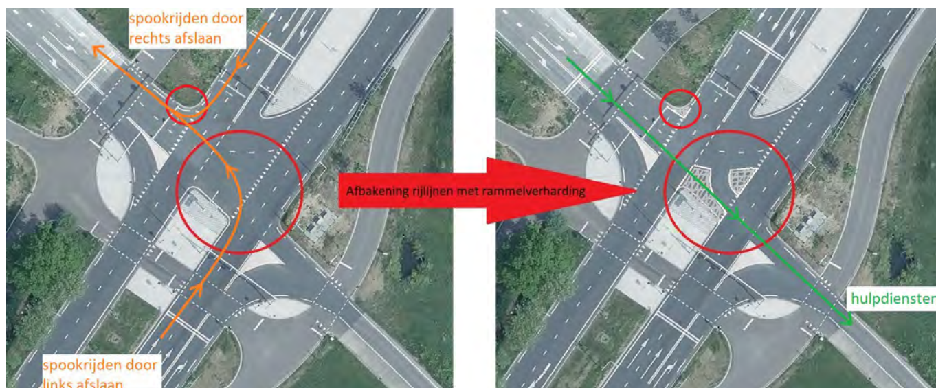
Afbeelding 4.2. Voorbeeld van toepassing van de afbakening van rijlijnen in een bestaande situatie (haarlemmermeeraansluiting). De middengeleider wordt doorgetrokken tot de rijcurve. Door gebruik te maken van basaltblokken blijft de doorgaande manoeuvre mogelijk voor hulpdiensten, maar is deze voor het overige verkeer niet comfortabel.
