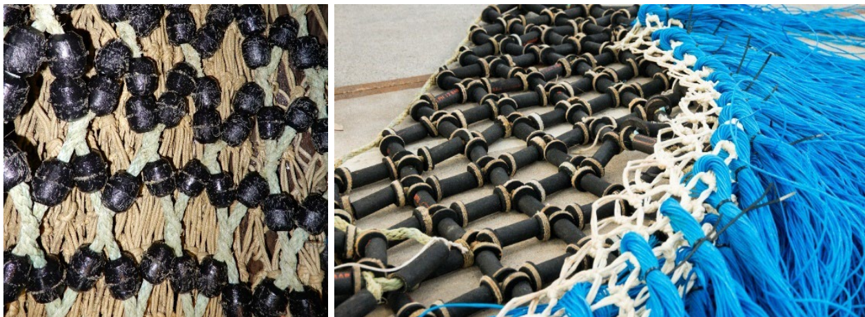
Figuur 3.3 Klossen met touwwerk aan boord van de TH10 (originele versie) en in het Visserij-innovatiecentrum Zuidwest-Nederland (aangepaste versie), inclusief conventioneel vispluis (blauw) Foto's: Albert Baaij.
