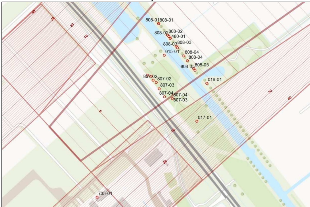
Figuur 8 - Objecten uit het luchthaven-bestand die conflicteren met Annex14-surfaces (2%-take-off climb surface approach surface en transitional surface).
