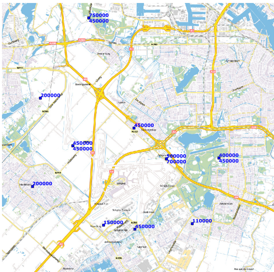
Figuur 10. Verhoudingen tussen de uiteindelijk geschatte ultrafijnstofbijdragen en berekende PM10-bijdragen van vliegtuigen.
