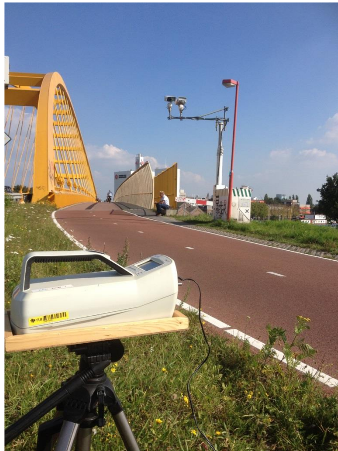
Figuur 24: Opstelling van de twee CPC 3007 apparaten. Op de voorgrond de benedenwindse meetpositie. De andere CPC staat op de computerkast van de brommerscan apparatuur. De foto is genomen in de richting van waar de wind vandaan kwam.
