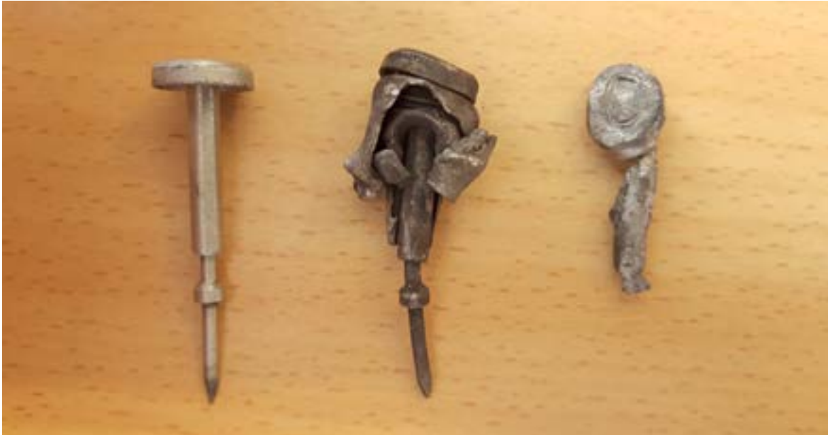
Figuur 12: Verschillende slagpinnen: links een ongebruikte slagpin, in het midden een slagpin uit de test in gewapende stand en rechts de slagpin uit het ongeval. (Foto: TNO)
