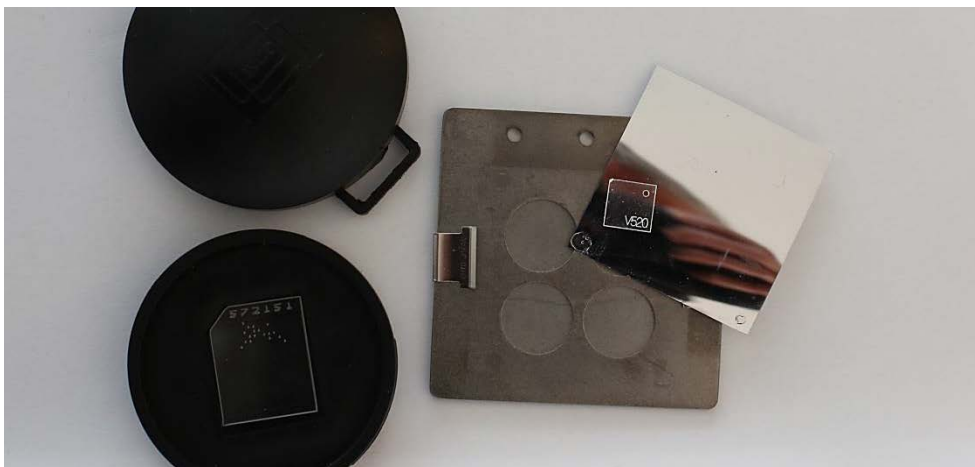
Figuur 1 Gedemonteerde radondetector (links) en thorondochterdetector (rechts).
