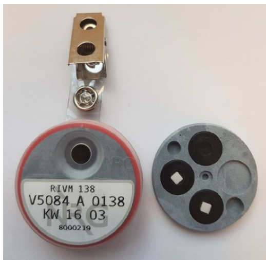
Figuur 2 Gedemonteerde gammadosismeter met rechts de binnenkant van de dosimeter met de twee voor de analyse gebruikte detectoren (Uit: de Jong, P. 2017)
