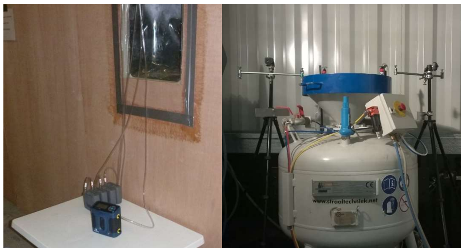
Figuur 9: Opstelling pompen buiten containment tijdens straalexperimenten (links), en meetopstelling in containment tijdens vulexperimenten (rechts).
