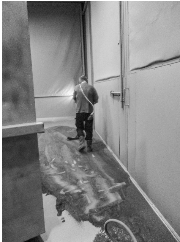
Meetlocatie 3: Scheppen / schuiven van gebruikt straalgrit in straalcabine
