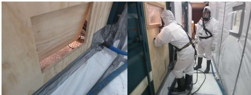
Figuur 7: Luik in de straalcontainer (links) en positie straler tijdens straalexperimenten (rechts).
