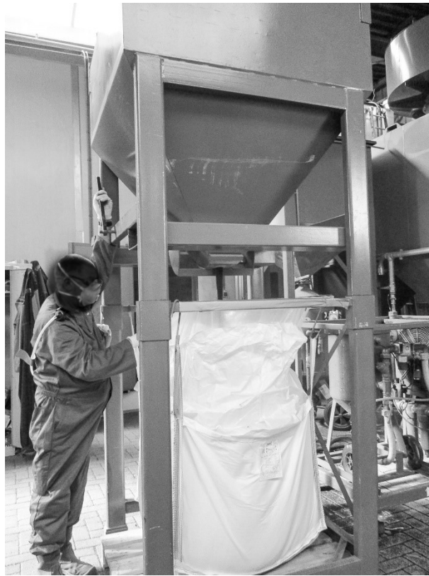
Meetlocatie 3: Vullen van bigbag vanuit vulsilo (handmatige bediening)
