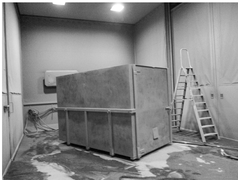
Meetlocatie 3: Stalen object (container) die is gestraald en schoongeblazen in straalcabine
