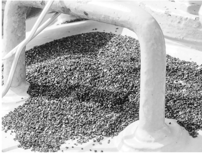
Meetlocatie 1C: Ongebruikt straalgrit op de rand van de straalketel na het vullen van de straalketel met zakken
