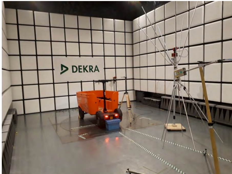
Figuur 15: [REDACTED] op de EMC opstelling van DEKRA te Arnhem
