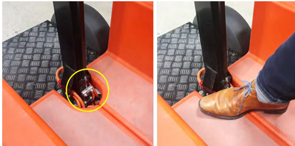
Figuur 11: Nieuw model Stint onbeschermd rembediening.
