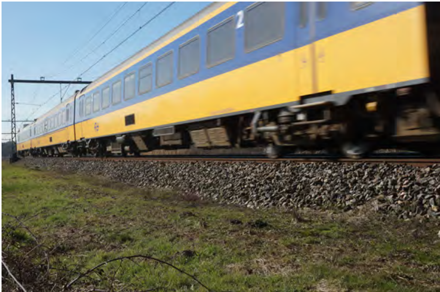
Afbeelding 9.3 Trillingen worden veroorzaakt doordat een trein passeert en daarbij de bodem in beweging brengt
