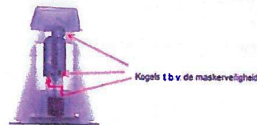
Foto 15: maskerveiligheid, boven de set-back kogel(17), onder de twee wapeningskogels(18)
