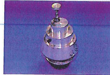
Foto 9: Gemodificeerde schokbuis M6-H voor doorslagtest. (Foto: KC W&M)
