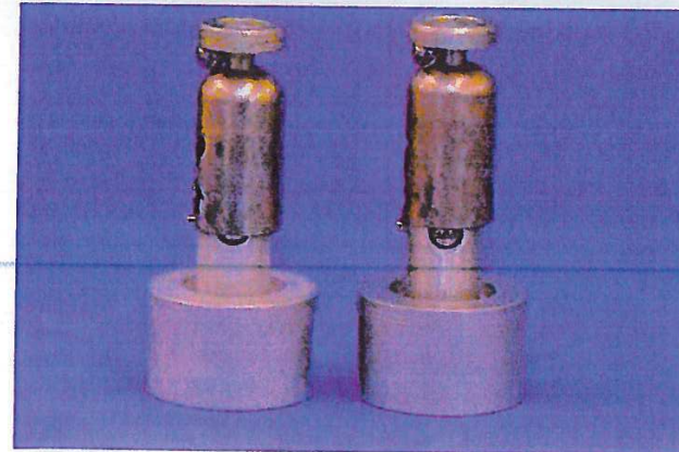
Foto 4: Combinatie slagpin en terugslagkap; links correct; rechts incorrect (Foto: KC W&amp;M)
