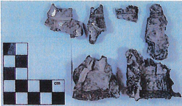
OVV-rapport figuur 25: Aluminium scherven afkomstig van de ongevalsgranaat. (Foto: TNO)
