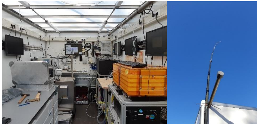
Figuur 3: Interieur van de meetwagen (foto links) en opzet van de snuivermast (ca 12 meter hoog) met anti-statische aanvoerleiding (foto rechts)
