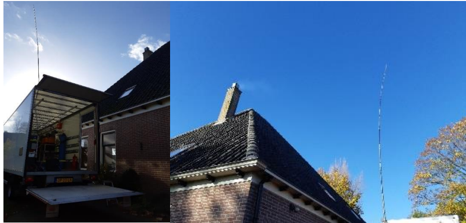
Figuur 2: Meetwagen met snuivermast: afstand ca 10 meter tot de schoorsteenmondning. Voorzijde (foto rechts) en achterzijde (foto links) van de gemeten schoorsteen. De houtrookpluim is zichtbaar op beide foto's.
