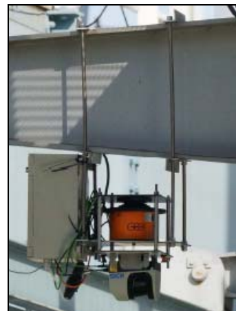
De proefmeetopstelling op en definitieve opstelling onder de spoorbrug te Nijmegen (foto's Fugro)
