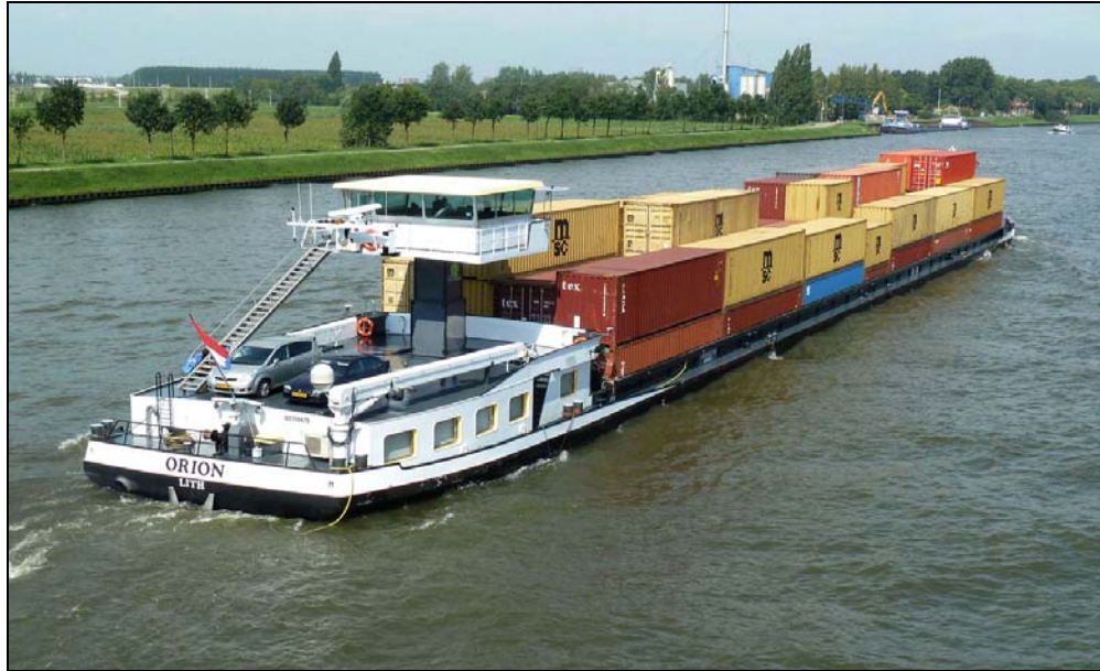
Klasse V schip met 3 lagen containers op het Amsterdam-Rijnkanaal (foto J.U. Brolsma)
