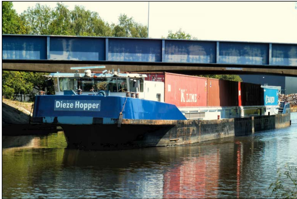
Met twee lagen containers past de Dieze Hopper juist onder de brug (foto J.U. Brolsma)
