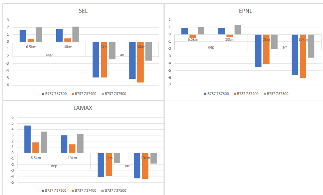
Figuur 25: Verschil in SEL, EPNL en LAmAx voor de Boeing 737 familie na toepassen geluidcorrectie.
