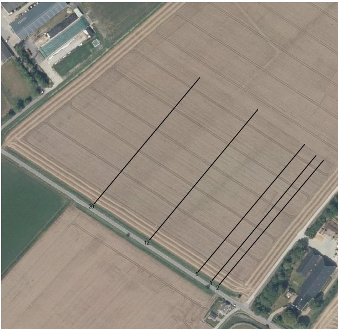
Fig. 2.4. Locatie drains waarvan de vlakteligging is gemeten.
