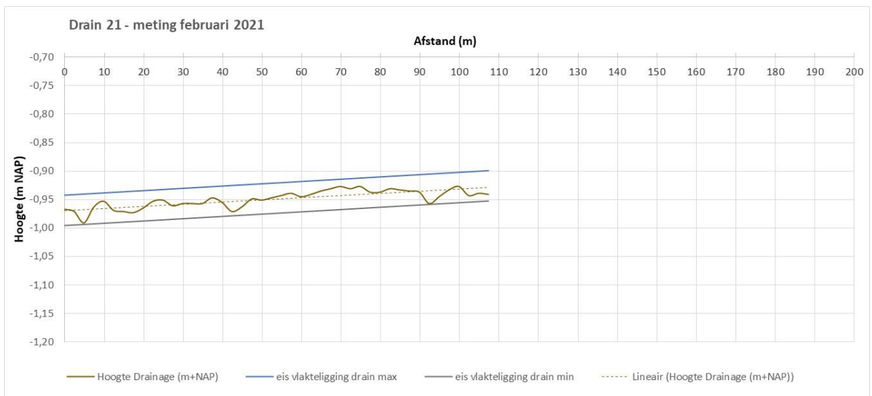
Fig. 3.10. Meting drain 21 en beoordeling risico op luchtinsluiting – meting februari 2021
