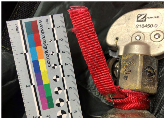
Figuur 19 Kop van drukfles met deel van de activatielus (bron IVD)
