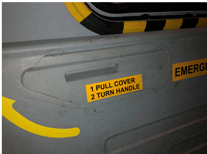
Figuur 14 Handgreep van raampees en afdekte hendel van het uitwerpmechanisme (bron IVD)
