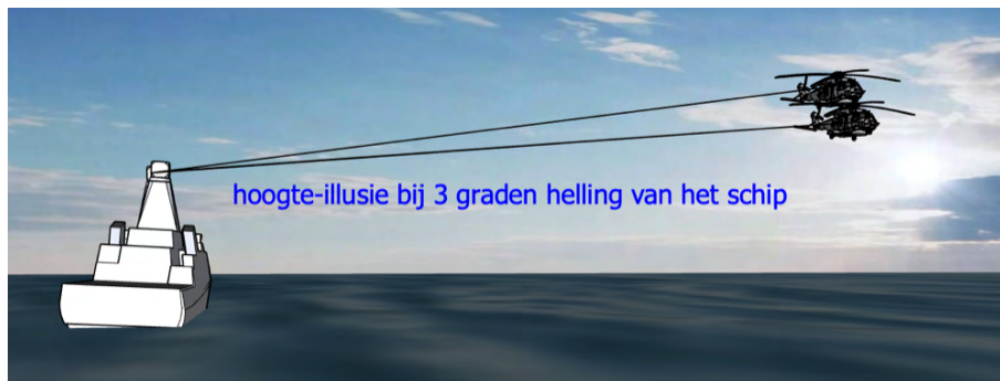
Figuur 12 Effect van helling van het schip op hoogteperceptie (bron IVD)
