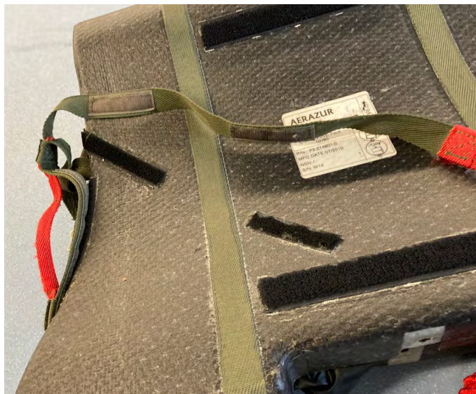
Figuur 27 Veiligheidslijn met klittenband (bron IVD)
