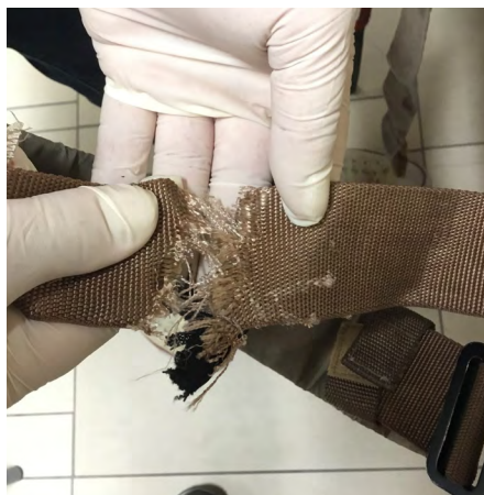
Figuur 20 Tijdens de redding doorgesneden deel van de band (bron IVD)
