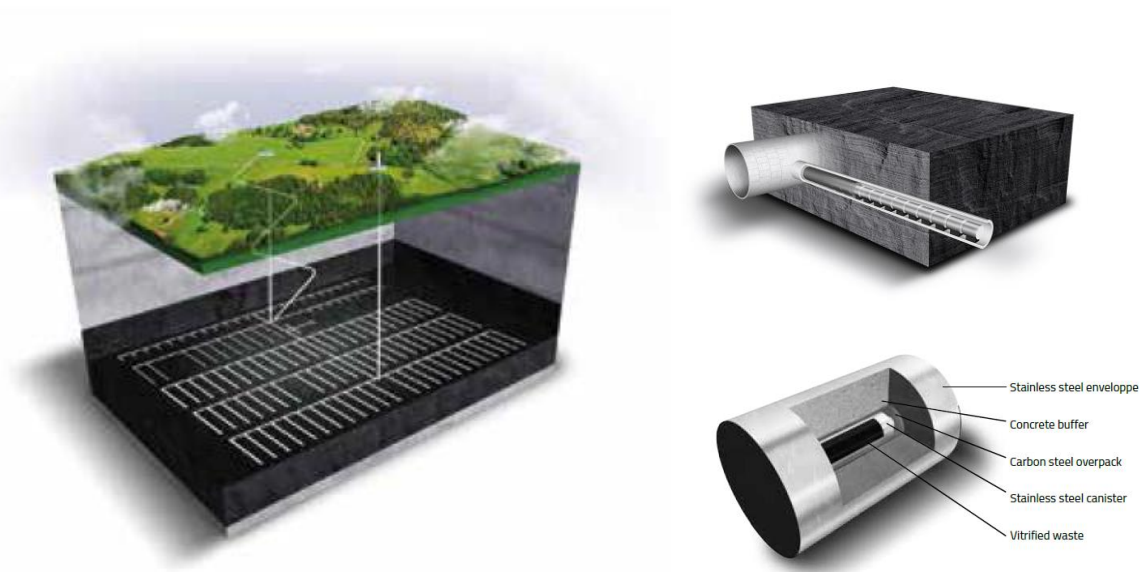
Figuur 10: OPERA concept voor de eindberging van radioactief afval in Boomse klei
