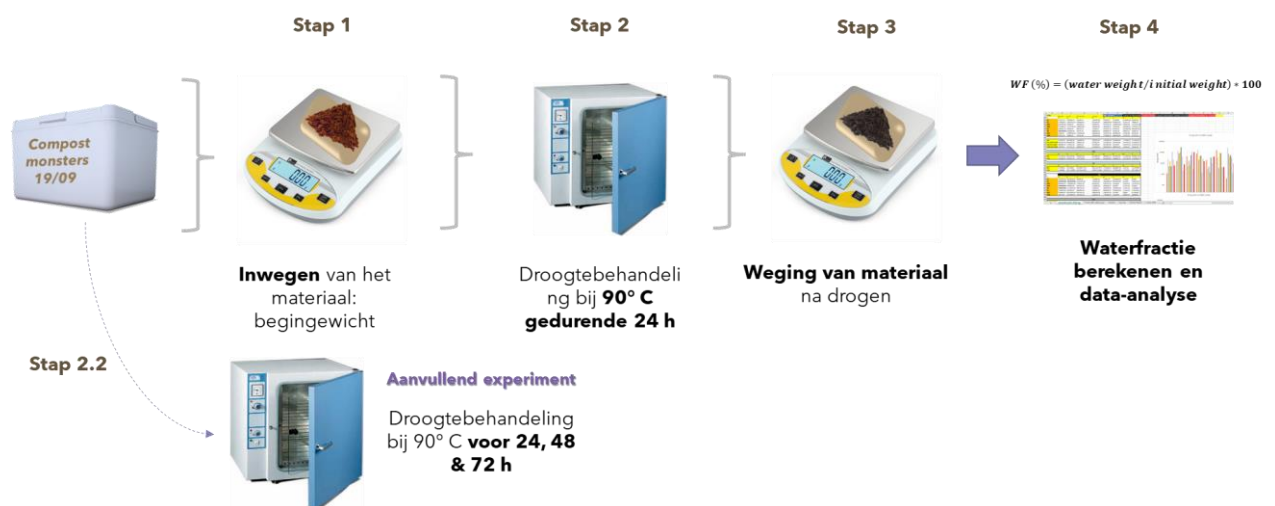
Figuur 4. Methodologie voor de schatting van de waterfractie via de 1L verzamelde monsters.
